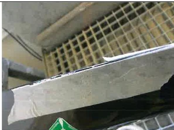
Если на передней кромке отслоилась стеклопластиковая оболочка, можно её приклеить. Дайте 5-минутной эпоксидной смоле втечь в трещину передней кромки.
