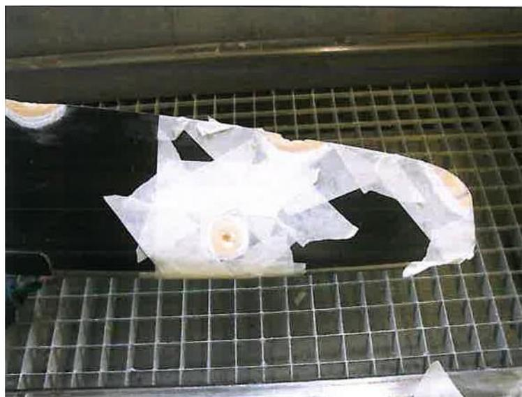
Если размер дефекта требует ремонта стеклопластиковой оболочки, полностью удалите краску и наполнитель в пределах около 1,2 см вокруг раковины и удалите слой композиционного материала резакром в направлении раковины.
