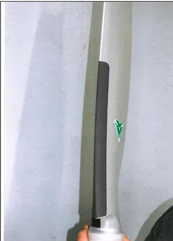
Неповреждённая противоабразивная оковка
