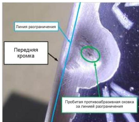
Повреждённый участок можно заполнить эпоксидной смолой; противобразивная оковка подлежит замене при ближайшем капитальном ремонте.
