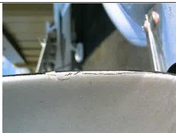
Продольные трещины можно заполнить 5-минутной эпоксидной смолой.
