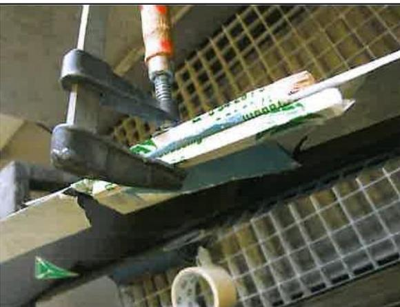
Затем прижмите переднюю кромку С-образными струбцинами и дайте эпоксидной смоле отвердеть.
