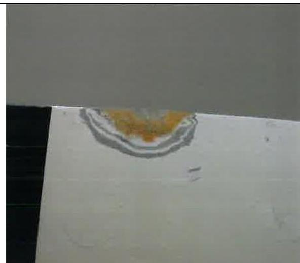
Отшлифуйте стеклопластиковое покрытие до получения гладкой поверхности, затем нанесите наполнитель и краску.
