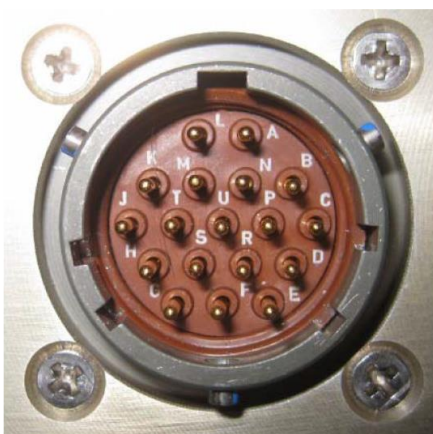
Рисунок 6.1. Вид разъёма MS27499E14B18P
