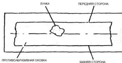
**6.4** Если противоабразивная оковка имеет лунки, указанные в п. 6.2.3.2, то она может быть пробита насквозь. Если оковка не пробита, действуйте как указано в п. 6.3. Если оковка пробита, осмотрите её на предмет наличия трещин. Если трещин нет, зашпаклюйте дефект эпоксидной смолой, чтобы влага не могла проникнуть в тело лопасти. Кроме того, нужно осматривать эту область при каждом предполётном осмотре на предмет наличия новых трещин. Нужно заменить оковку как можно скорее.
